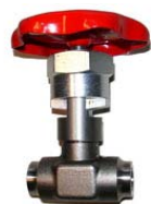
KLA-824944 NÅLVENTIL PN250 rostfritt stål SS 2383 svetsändar ISO rör MAX TEMP 540°C
