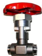
KLA-824943 NÅLVENTIL PN250 syrafast stål SS 2348 invändig gänga MAX TEMP 540°C
