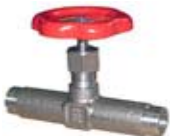
KLA-46202 NÅLVENTIL PN 100 kolstål C 22.8 svetsändar
