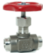
KLA-46202 NÅLVENTIL PN 400 syrafast stål SS 2348 svetsändar
