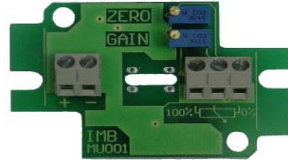
Nivåtransmitter 3-tråds potentiometerkrets
